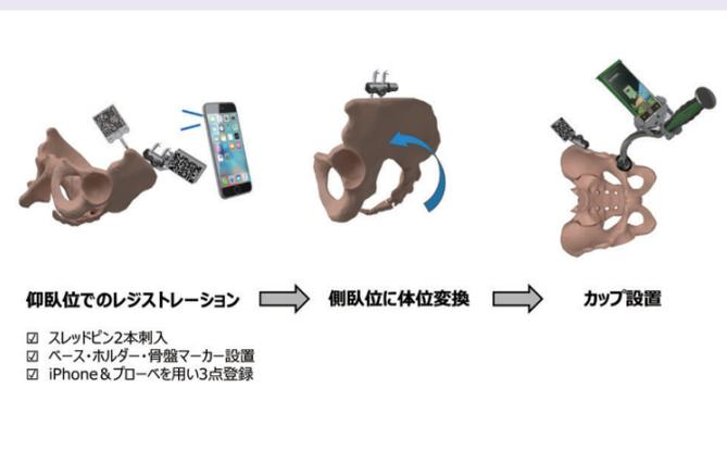
図3 側臥位人工股関節全置換術でのAR Hip Navigationの手順
